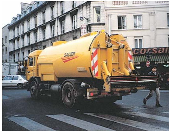
Matériel classique utilisé pour le nettoyage des revêtements urbains.
