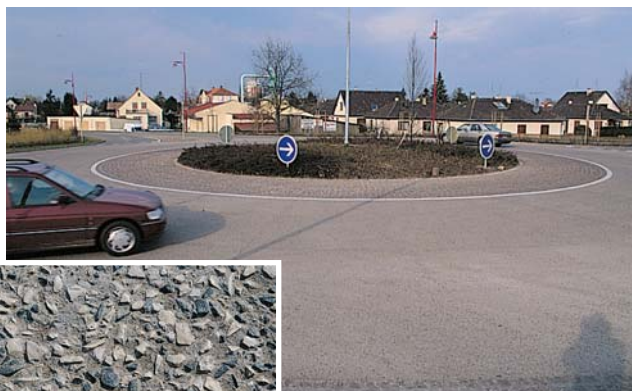
Le béton désactivé, ainsi qu'un choix adéquat des gravillons (couleur, dureté, etc.) est la solution idéale pour les carrefours giratoires urbains.
