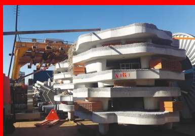
Dalles Rague en béton bicouche de Seabost, sur la quais, avant leur mise à l'eau dans la calanque de Cortiou.
