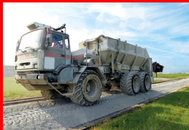
L'épandeur distribue avec précision le liant hydraulique.
