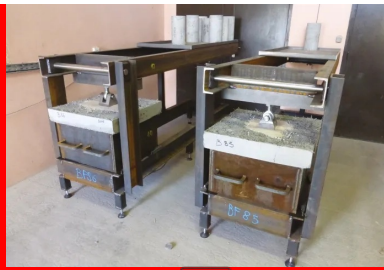
Essais de fluage par poinçonnement-flexion en cours sur les bâts.
