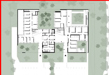
Plan de rez-de-chaussée 1. Hall d'entrée de la partie dédiée aux enfants 2. Hall d'entrée de la partie dédiée aux adultes 3. Zone « tampon » réservée au personnel et séparant les deux parties du centre
