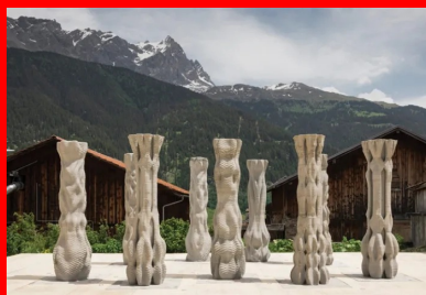
Colonnes imprimées en béton 3D - ETH Zurich
