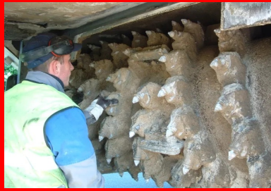
Détail du rotor du malaxeur
