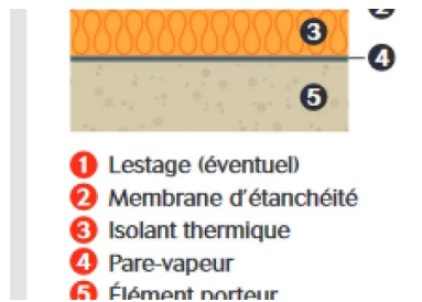
TT - Structure d'une toiture "chaude" Fig.1
