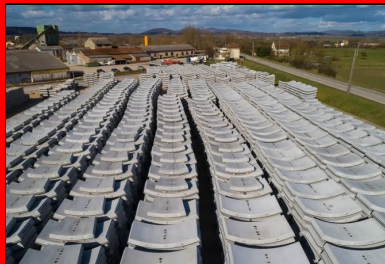
© ACTOPHOTO Stockées à l'extérieur de l'usine, les piles de voussoirs représentent chacune un anneau complet rangé dans l'ordre de pose du tunnelier.
