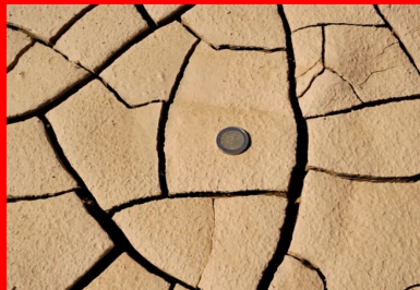
Forte sensibilité des matériaux lessivés : exemple d'une poche de matériau sec dans un dépôt après un épisode de forte chaleur.
