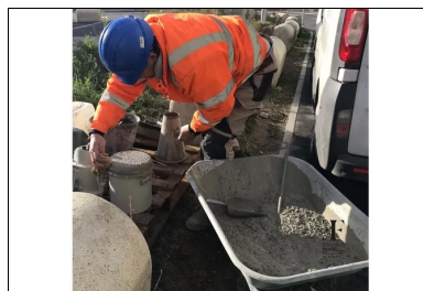
Contrôle qualité du béton frais.
