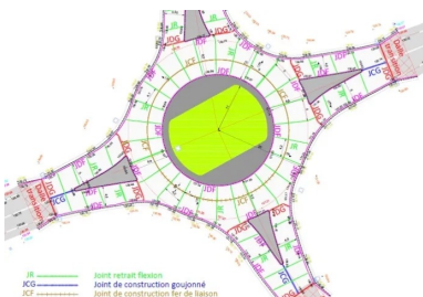
Plan de calepinage du carrefour giratoire. (© Marylène Redouani, CD 76)
