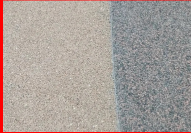
Aspect des deux bétons drainants, clair et foncé. (©Alex Jambon, Sols)
