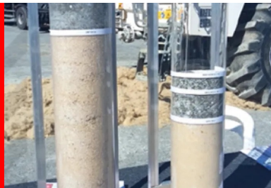
Photo 1 : éprouvettes avec la différence d'épaisseur de structure entre matériaux granulaires et couche de forme traitée (c) CIMbéton
