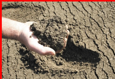
Le matériau BCR est constitué de granulats, de liant hydraulique (ciment ou LHR), d'eau et éventuellement d'adjuvants. (©Cimbéton)
