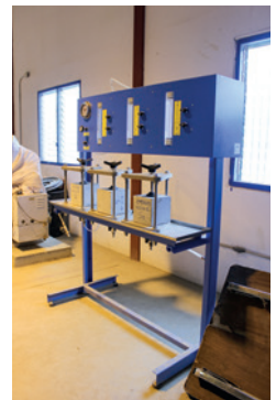
18d. Essai de perméabilité à l'eau d'un béton durci (image Shutterstock)
