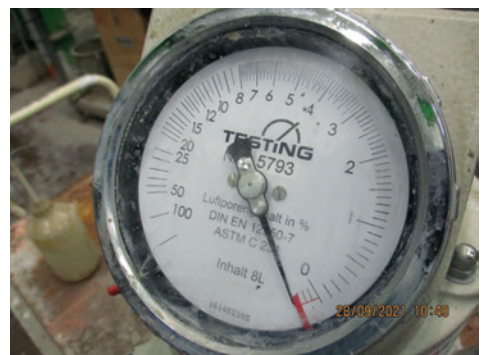
18e. Aéromètre, mesure de la teneur en air occlus du béton frais (crédit GCP)
