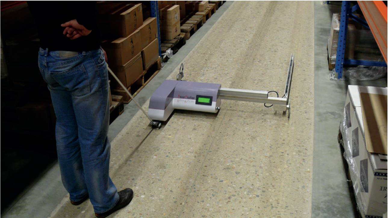
40. Contrôle au profilographe - (crédit SOREDAL)
