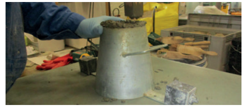
18b et 18c. Essai à l'étalement du béton frais pour en mesurer la consistance, l'ouvrabilité - (crédit GCP)
