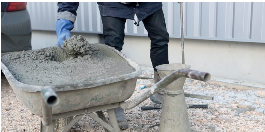
38. Contrôle de la consistance : affaissement au cône d'Abrams - (crédit SOREDAL)
