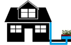
Constitué d'une **surface plantée au contact direct d'un réservoir d'eau de pluie**, il est connecté de façon étanche aux descentes d'eaux pluviales
